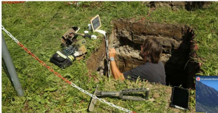
Bis zur schweizerischen Wetterstation von MeteoSchweiz in Andermatt (UR) werden 40 Sensoren installiert, um die Bodenfeuchtigkeit messen zu können. Die messen nationale Messnetz wird umfassende Daten zum Bodenwasserstand liefern. Mehrere Daten zur Trockenheit in der Schweiz erfassen. Bei Standort Andermatt ist Teil eines nationalen Messnetzes, das bis 2027 entsteht.
