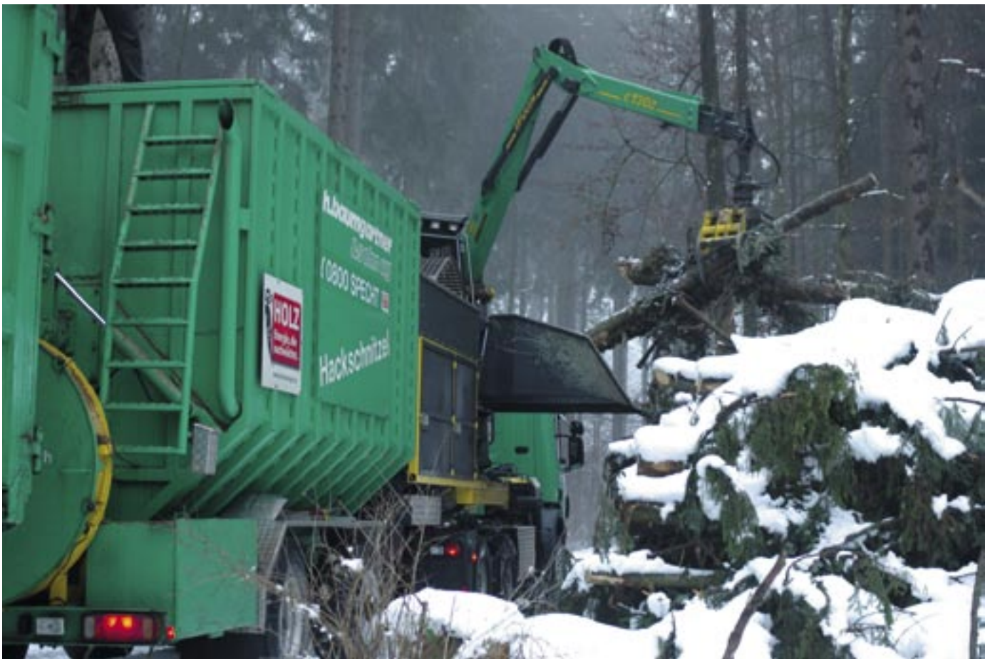
Abb. 15: Der Hacker bei der Arbeit. Es werden die ganzen Bäume samt Ästen und Krone gehackt. Auf dem Bild ist der Bunker zu sehen, welcher gefüllt wird, während der volle Lastwagen zur Heizzentrale fährt.
