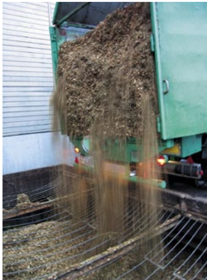
Abb. 16: Der Lastwagen lädt die Holzschnitzel in der Heizzentrale «Gern» in Winterthur-Hegi ab.
