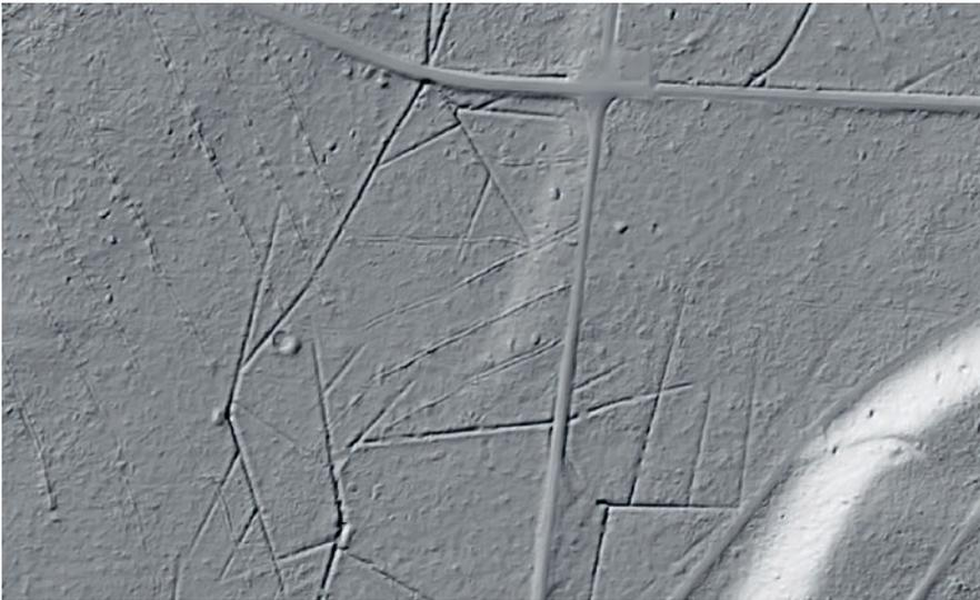
Die feinen, doppelten Linien kennzeichnen sichtbare Fahrspuren, die dicken, dunklen Linien Entwässerungsgräben und die glatten, breiten Linien Strassen.
